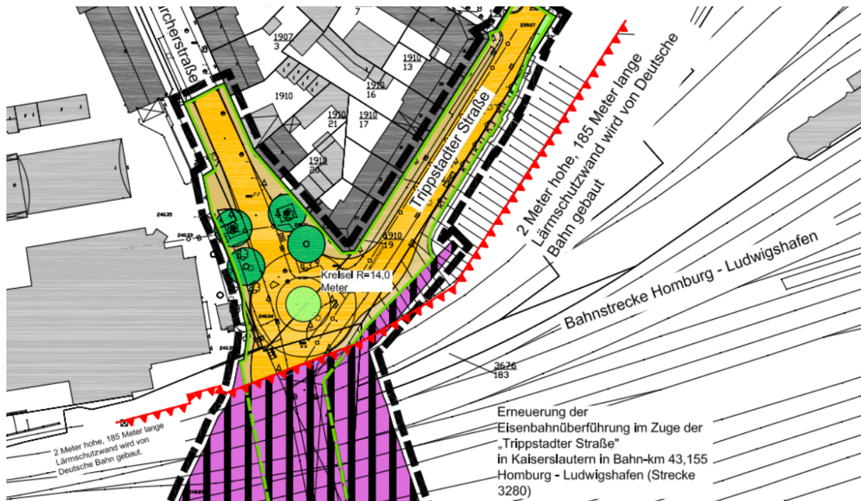
Abbildung 14: Lärmschutzwand zur Reduktion der Lärmbelastung durch den Schienenverkehr. 48 Die Planung des Kreisverkehrs wurde inzwischen zu einem Knotenpunkt mit Lichtsignalanlage geändert.
