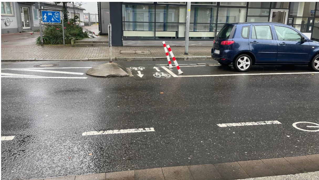
Abbildung 29: Burgstraße auf Höhe des Burggymnasiums (19.10.2023). Parkende Autos zwischen Radfahrstreifen und Fahrbahn. Schmäler markierter Bereich zum Wechseln der Straßenseite für Fahrradfahrer.
