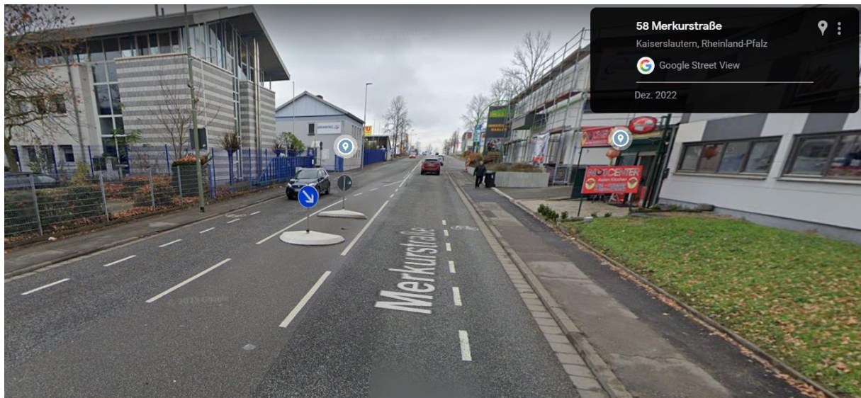
Abbildung 49: Merkurstraße (Google Street View). Beginn bzw. Ende des beidseitigen Schutzstreifens.
