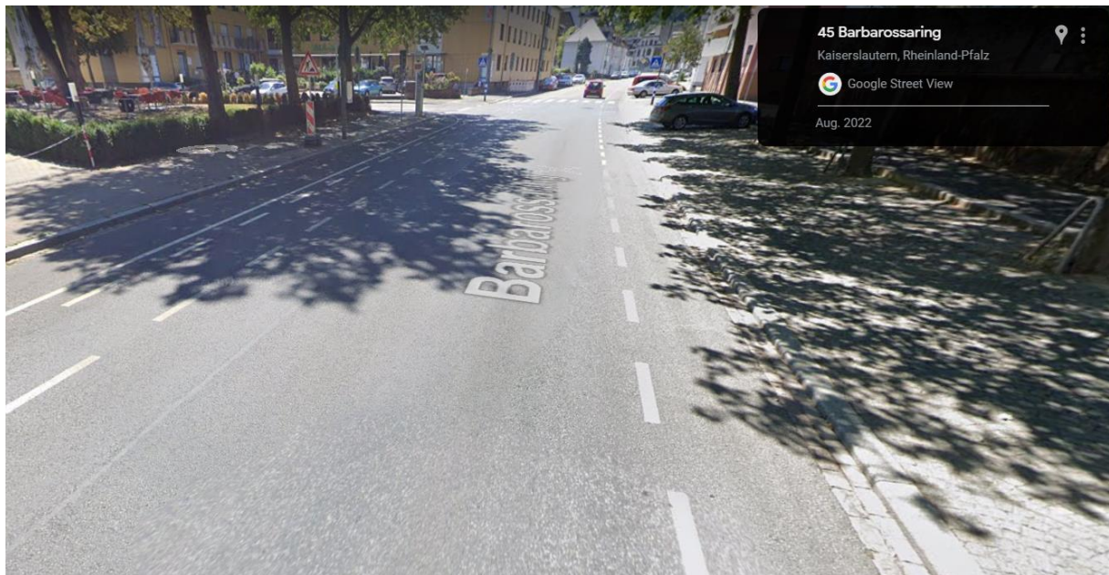
Abbildung 10: Barbarossaring auf Höhe des Hotels Hampton mit Blick Richtung Süden (Google Street View). Beidseitiger Schutzstreifen. Seitliche Parkplätze an der östlichen Straßenseite (links), Parkplätze quer zur Straße an der westlichen Seite (rechts), obwohl außer während der Kerwe der Messeplatz als Parkplatz zur Verfügung steht.
